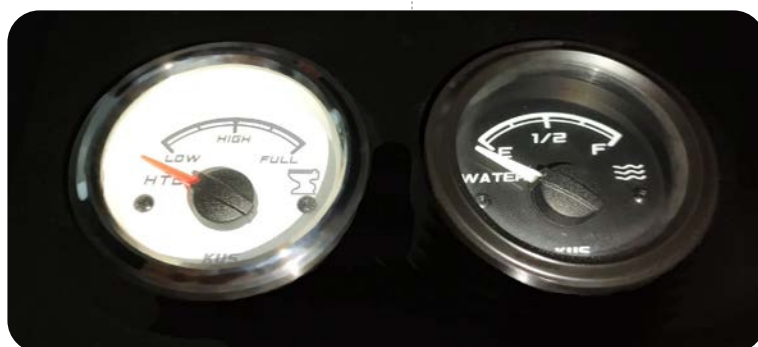
Rys. 4.11. Wskaźnik zbiornika wody / ścieków.
